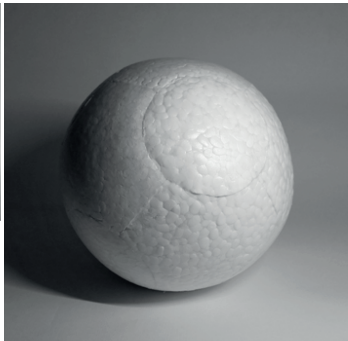
Mark Burghoffs Modell eines Fußballs, der aus wenigen (miteinander verschweißten) Infinergy®-Stücken zusammengesetzt wurde Mark Burghoff's model of a football that consists of just a few (welded to each other) pieces of Infinergy®
