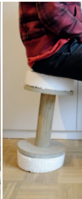
an 1:1 Modellen überprüft Simon Pöppinghege, wie sich die Sitzposition auf einem Hocker verändert, wenn verschiedene Bauteile aus Infinergy® bestehen 1:1 models help Simon Pöppinghege to examine the sitting position on a stool, when various parts are replaced by Infinergy® components
