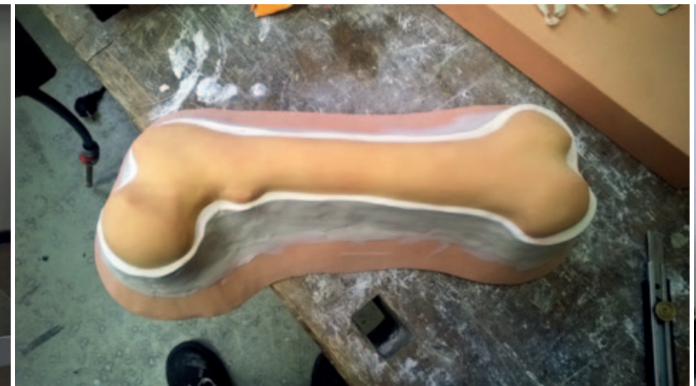
der Hundeknochen aus Modellbauschaum dient als Urform für das Formwerkzeug aus Gips the dog bone made of modelling foam serves as master form for the plaster mould
