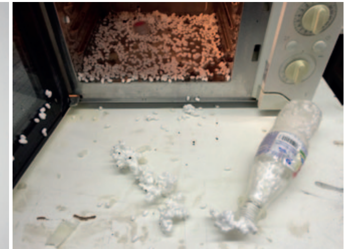
ein gescheiterter Test Infinergy® in der Mikrowelle zu verarbeiten a failed attempt to process Infinergy® in a microwave oven
