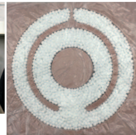
Infinergy®-Partikel werden in einem Formwerkzeug aus Modellbauschaum verpresst und verklebt Infinergy® beads are pressed and glued inside a moulding tool made from modelling foam
