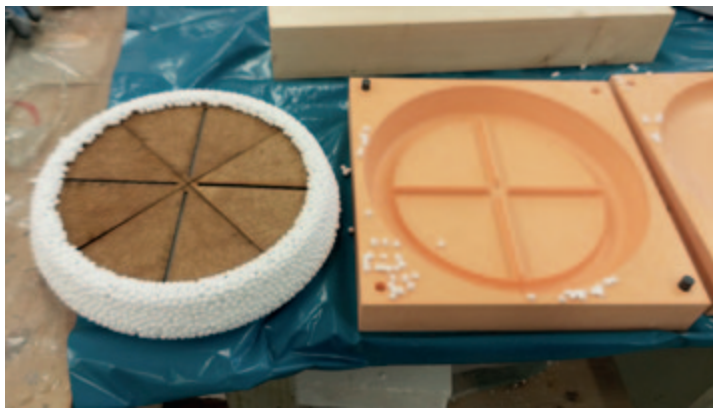
ein Sitzkissen aus Infinergy® und das dazugehörige Formwerkzeug von Simon Pöppinghege a seat cushion made of Infinergy® and its corresponding moulding tool by Simon Pöppinghege
