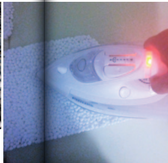
Infinergy®-Partikel werden mit einem Bügeleisen zu einem textilartigen Material verschmolzen Infinergy® beads are welded with an iron into a textile-like material
