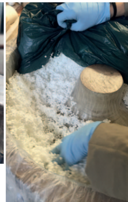
Birgit Hengstebeck füllt Infinergy®-Partikel in ihr Formwerkzeug Birgit Hengstebeck fills Infinergy® beads into her moulding tool
