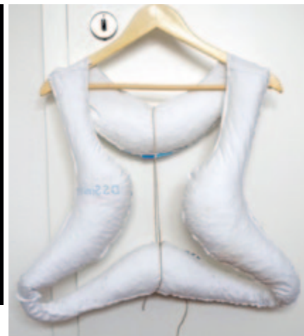
ein mit Infinergy®-Partikeln befülltes textiles Modell dient zur Überprüfung des Tragekomforts der Schwimmweste a textile model filled with Infinergy® beads helps to test the wearing comfort of the life jacket
