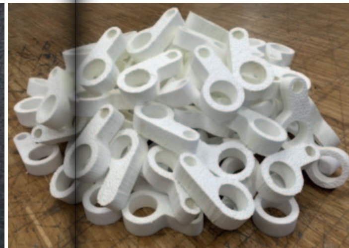
per Wasserstrahlschnitt erzeugte Infinergy®- Module von Birgit Hengstebecks Lattenrost water-cut Infinergy® modules of Birgit Hengstebeck's slat frame
