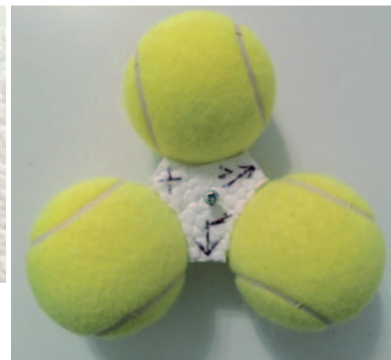
ein weiteres Klemmprinzip für einen Kleiderhaken, das Helen Peper mit Hilfe von drei Tennisbällen überprüft another clamping principle for a coat hanger is tested by Helen Peper with the help of three tennis balls
