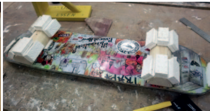
Julian Hensels Mock-Up Modell eines Indoor-Skateboards mit geräuschkämpfenden Achsen aus Infinergy® Julian Hensel's mock-up model of an indoor skateboard with noise-reducing trucks made of Infinergy®
