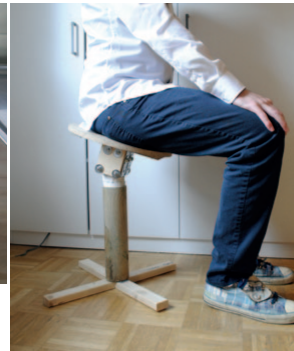
an 1:1 Modellen überprüft Simon Pöppinghege, wie sich die Sitzposition auf einem Hocker verändert, wenn verschiedene Bauteile aus Infinergy® bestehen 1:1 models help Simon Pöppinghege to examine the sitting position on a stool, when various parts are replaced by Infinergy® components
