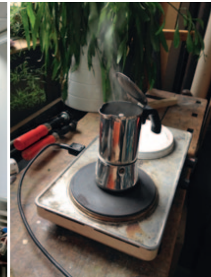
der industrielle Verarbeitungsprozess wird im Kleinen mit einem handels-üblichen Espressokocher erprobt the industrial process is tested on a small scale with the help of a customary espresso maker
