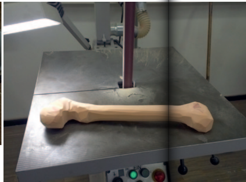
die finale Form von Sabet Regnerys Produkt wird aus dem vollen Material mit Hilfe eines Schleifbands herausgearbeitet the final shape of Sabet Regnery's product is fleshed out of the solid material with the help of a sanding belt
