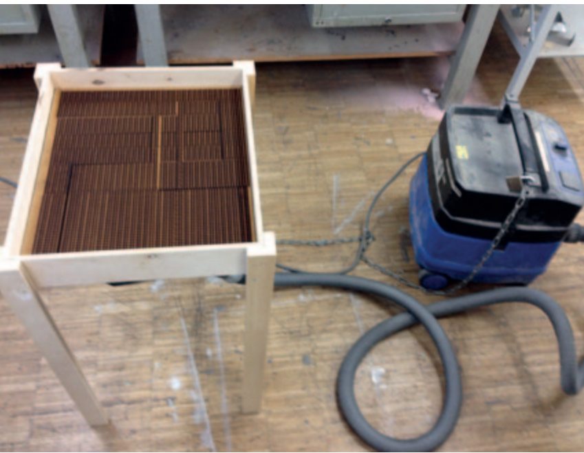
Versuchsapparatur um Infinergy®-Partikel mit Hilfe eines Staubsaugers in einem Raster anzuordnen experimental setup to arrange Infinergy® beads in a grid with the help of a vacuum cleaner
