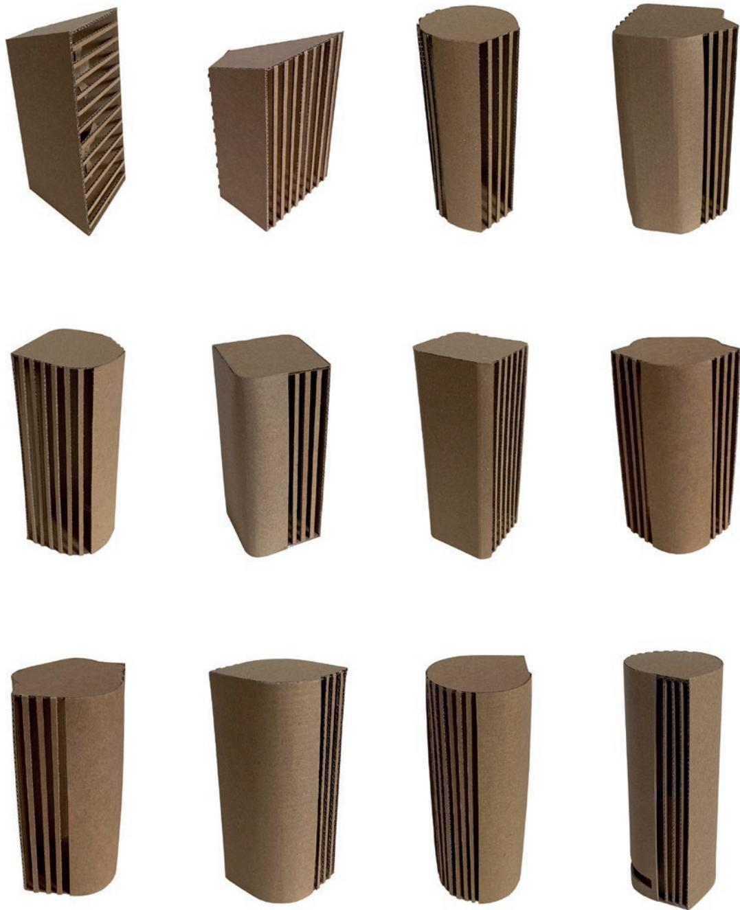
Der Designprozess zeichnete sich durch den Bau von vielen Modellen aus Pappe im Maßstab 1:1 aus. Diese Modelle lieferten Aufschluss in Bezug auf die Proportionen sowie Hinweise darauf, wie unterschiedliche Geometrien den Luftstrom beeinflussen.
