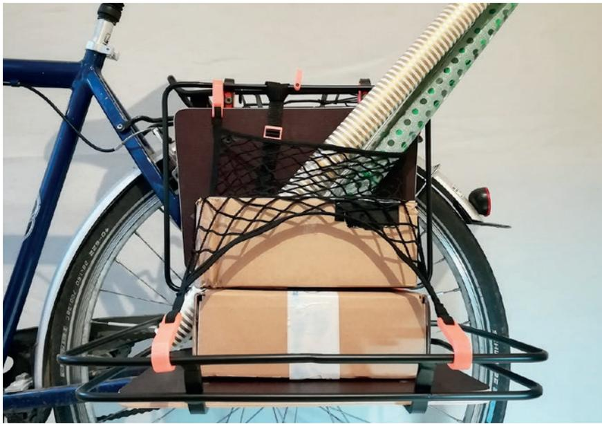
Die dauerhaft montierte Ladefläche lässt sich an den vorhandenen Gepäckträger montieren. Geschlossen ist sie schmal und nicht störend im Alltag. Aufgeklappt bietet sie eine große Fläche für den spontanen Transport. Dazu dienen zusätzlich ein Spannetz und ein Spanngurt, die vielseitig zum Einsatz kommen können und für größere Ladungen die passende Sicherungsmöglichkeit bieten.
